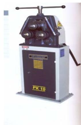
Slika 3. Mašina za savijanje cevi tipa PK-10 –minimalni radius savijanja veći od 3xd
