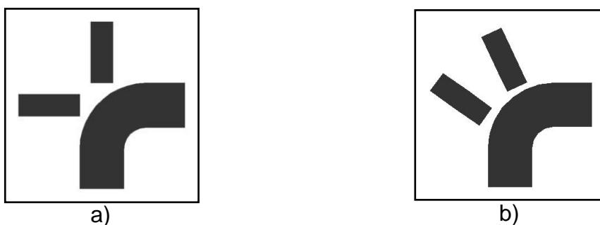
**Slika 3. Saobraćajni znakovi koji prikazuju pravac pružanja prioritetnog pravca na nestandardnoj nesignalisanoj raskrsnici (u oznaci IV-23)**
