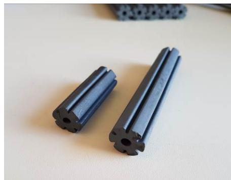
Slika 1. Primjenjena feritne cevčice sa žlebovima dužina 40 mm odnosno 80 mm.
