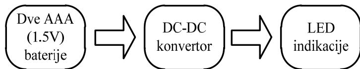
Slika 7. Blok sema napajanja uređaja
